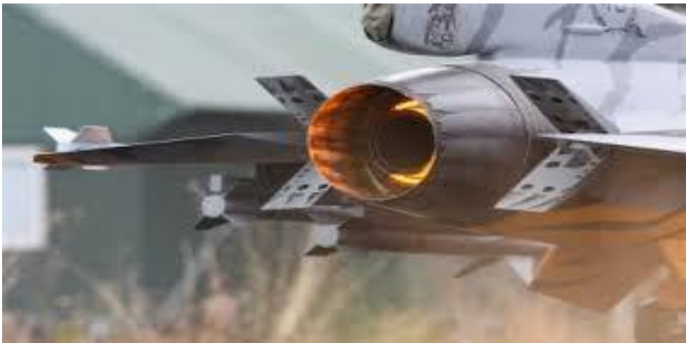
Şekil 5.16: F-16 aerodinamik frenler
